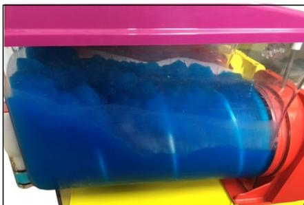
**Achtung! Wenn Sie die Behälter nicht mehr nachfüllen und die Kühlzylinder schon größtenteils zu sehen sind, stellen Sie die Kühlung bitte auf Stufe 2 = Kühlen (Cold).**
